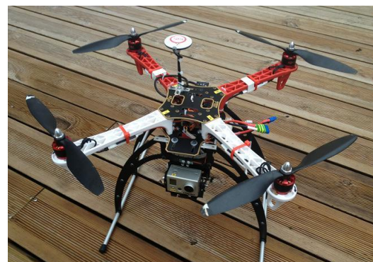
Drone multirotors stabilisé par gyroscopes et GPS, équipé de sa caméra.
