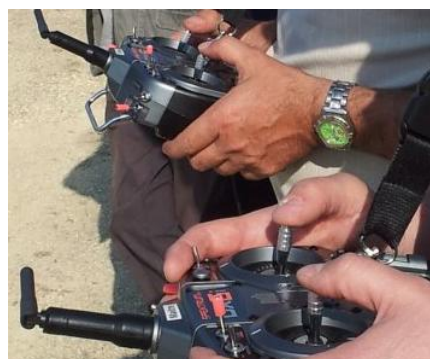
Le vol est sécurisé par 2 radiocommandes reliées ensemble, une pour le moniteur, une pour le stagiaire.
